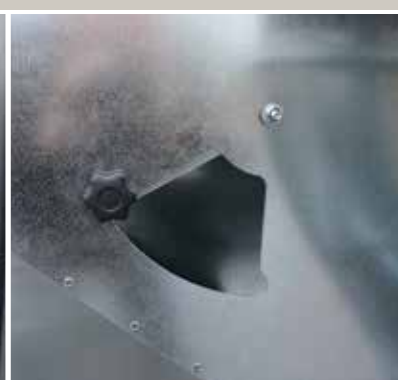
Usa de acces pentru colectare de mostre de cereale curatate
